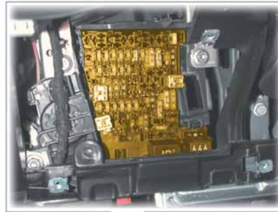
Sicherungs- und Relaisträger unterhalb der Schalttafel links
