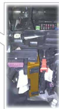
Bordnetzsteuergerät unterhalb der Schalttafel links
