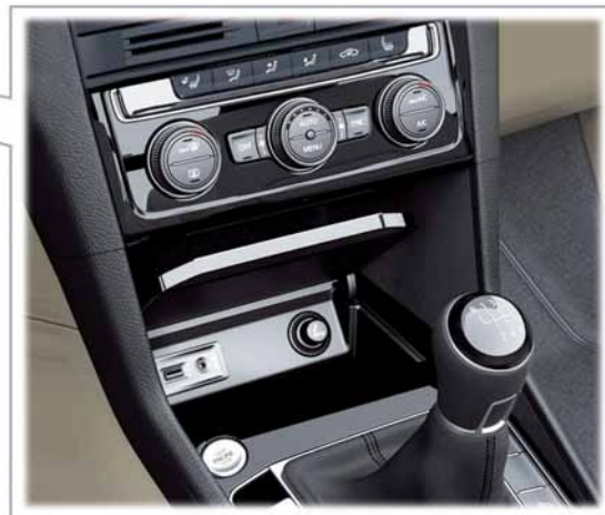
Bedienteil Klimatisierung, Mobiltelefonschnittstelle „Comfort“, Medienschnittstellen USB und AUX-IN
