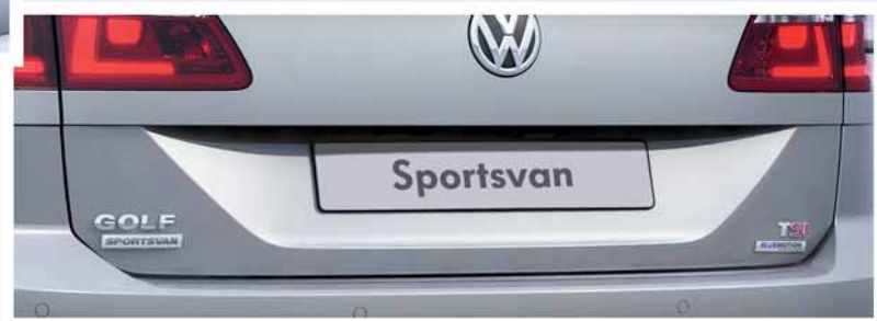
Heckklappe mit größerem Bereich der Kennzeichenaufnahme
