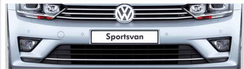
Stoßfänger vorn mit integrierten Nebelscheinwerfern
