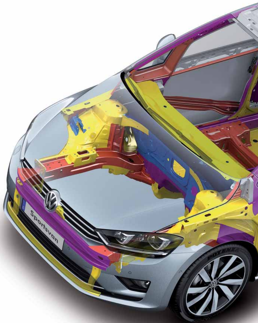
Anteile der Stahlbleche nach Festigkeiten
