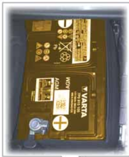
Batterie im Motorraum links
