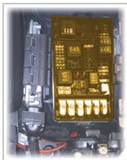
Hauptsicherungs- und Relaisträger im Motorraum links
