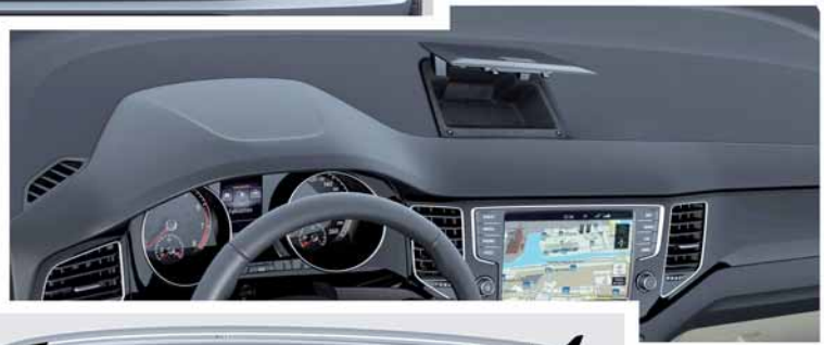
Ablagefach in der Schalttafel oben
