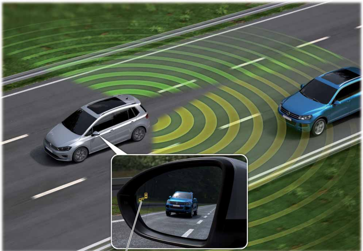
Warnleuchte für Totwinkelerkennung im Außenspiegel links K303
