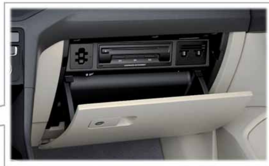
Handschuhfach mit Steuergerät für Informationselektronik (optional)
