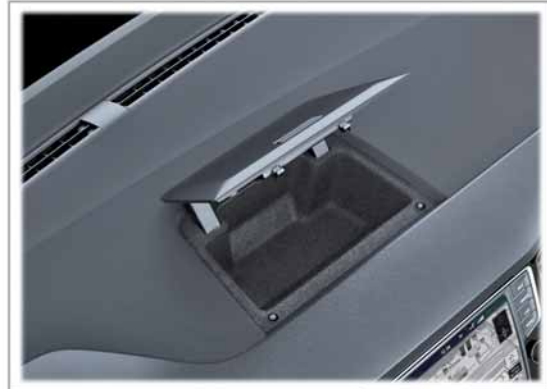
Ablagefach mit Deckel auf der Schalttafel
